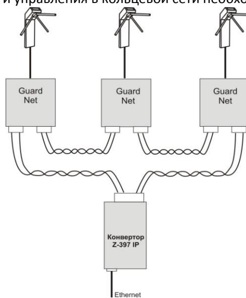
Контроллеры и конвертер автоматически обнаруживают кольцевое соединение и переходят в соответствующий режим работы. При этом не требуется управление с компьютера и сеть может работать в автономном режиме.
