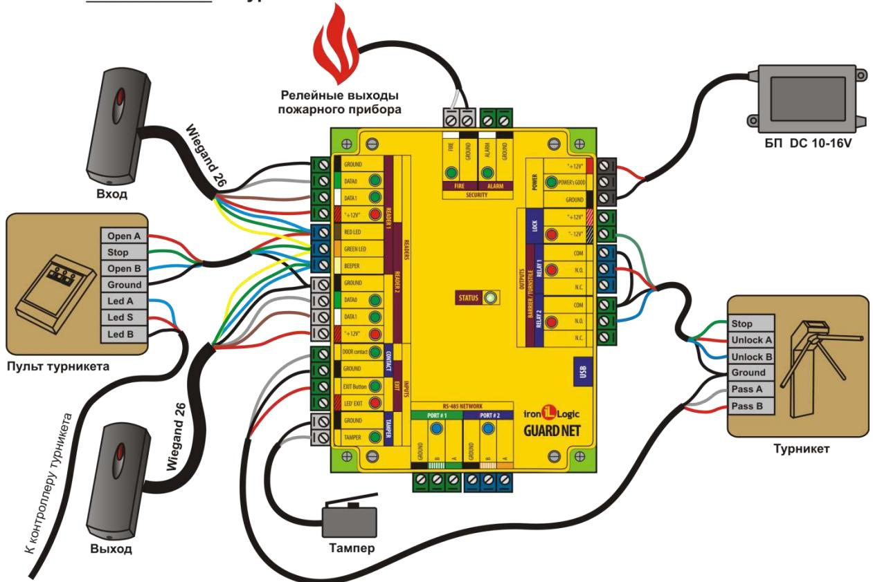
**Считыватели** – могут быть использованы любые считыватели, работающие по протоколам Wiegand 26 или Dallas Touch Memory. На схеме показан пример подключения считывателя работающего по протоколу Weigand. Для подключения по протоколу Dallas используется следующая схема:
