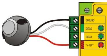
Контроллер поддерживает режим прохода по ключу с предварительным вводом пароля (при подключении считывателя Matrix-IV EH Keys).
