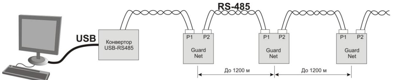
Такая схема сети позволяет снять ограничения на общую длину линии связи. Кроме того, при таком включении, облегчается обнаружение повреждённого участка сети, а все участки сети до повреждённого, продолжают нормально функционировать.
