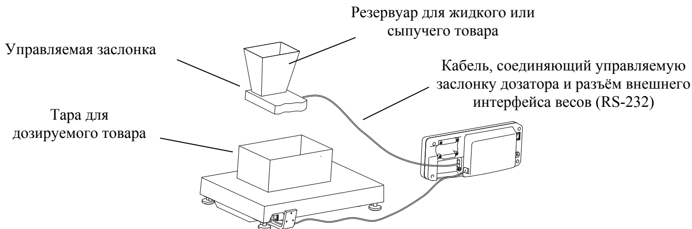
Рис. 7.2 - Подключение весов к дозирующему устройству
